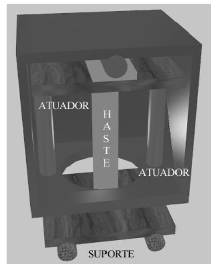
Figura 5 – Layout do micro robô desenvolvido por S. Fatikow (Fatikow, 1997).
